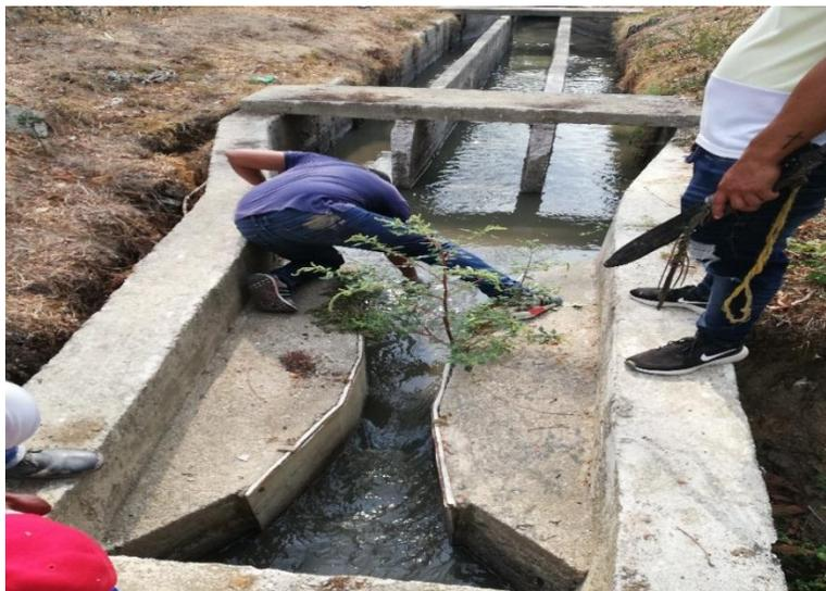
**Figura 13.** Toma de muestra y medición de caudal en la canaleta parshall.
