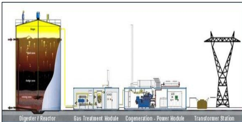
**Figura 44.** Diagrama del proceso de generación de energía
