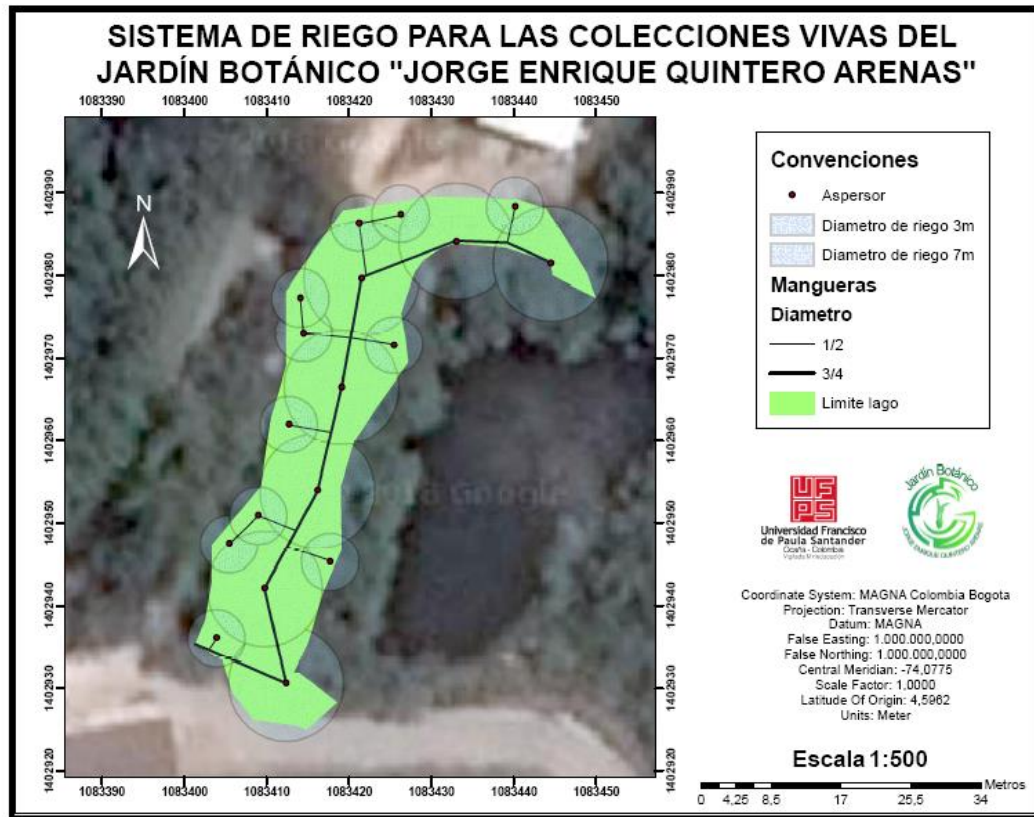
Ilustración 5. Distribuciones del sistema de riego para el jardín botánico. Fuente: Jardín Botánico “Jorge Enrique Quintero Arenas
