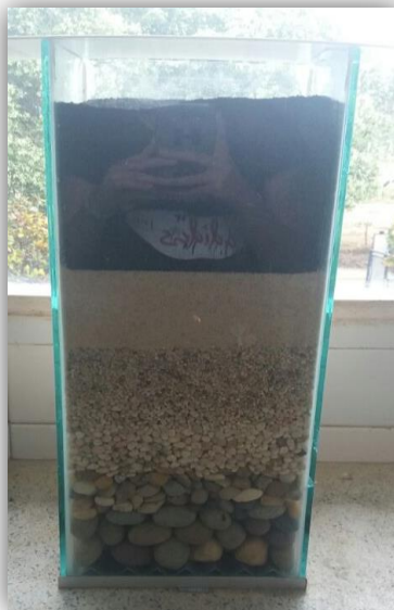
Fotografía 16. Lecho filtrante. Fuente: Autora de la pasantía.
