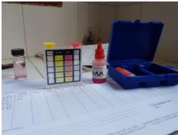
*Ilustración 22* Equipos que se utilizan para realizar la prueba de pH. (Fuente: autores 2019)
