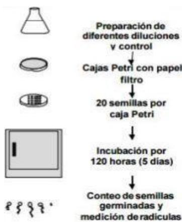
**Figura 7.** Diagrama esquemático de la prueba de toxicidad aguda. Fuente: (Sarabia, s.f)
