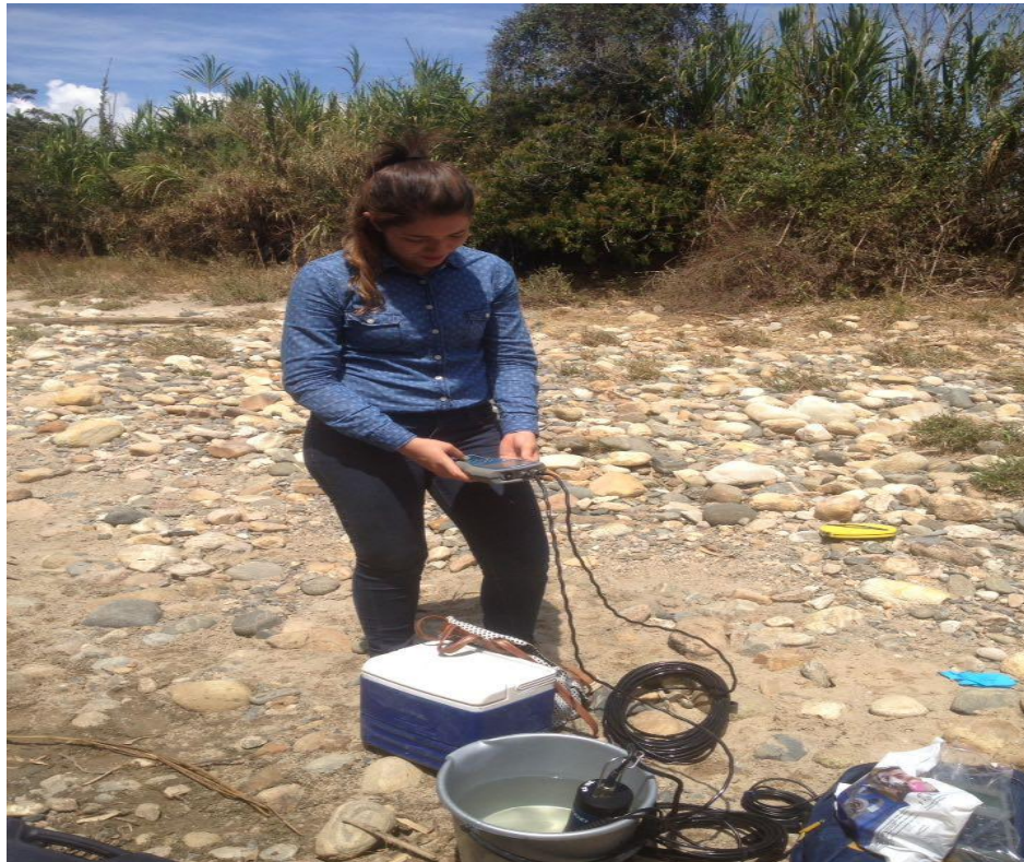
Figura 19. Medición de Parámetros OD, Turbidez, T°, Color, pH, Conductividad.
