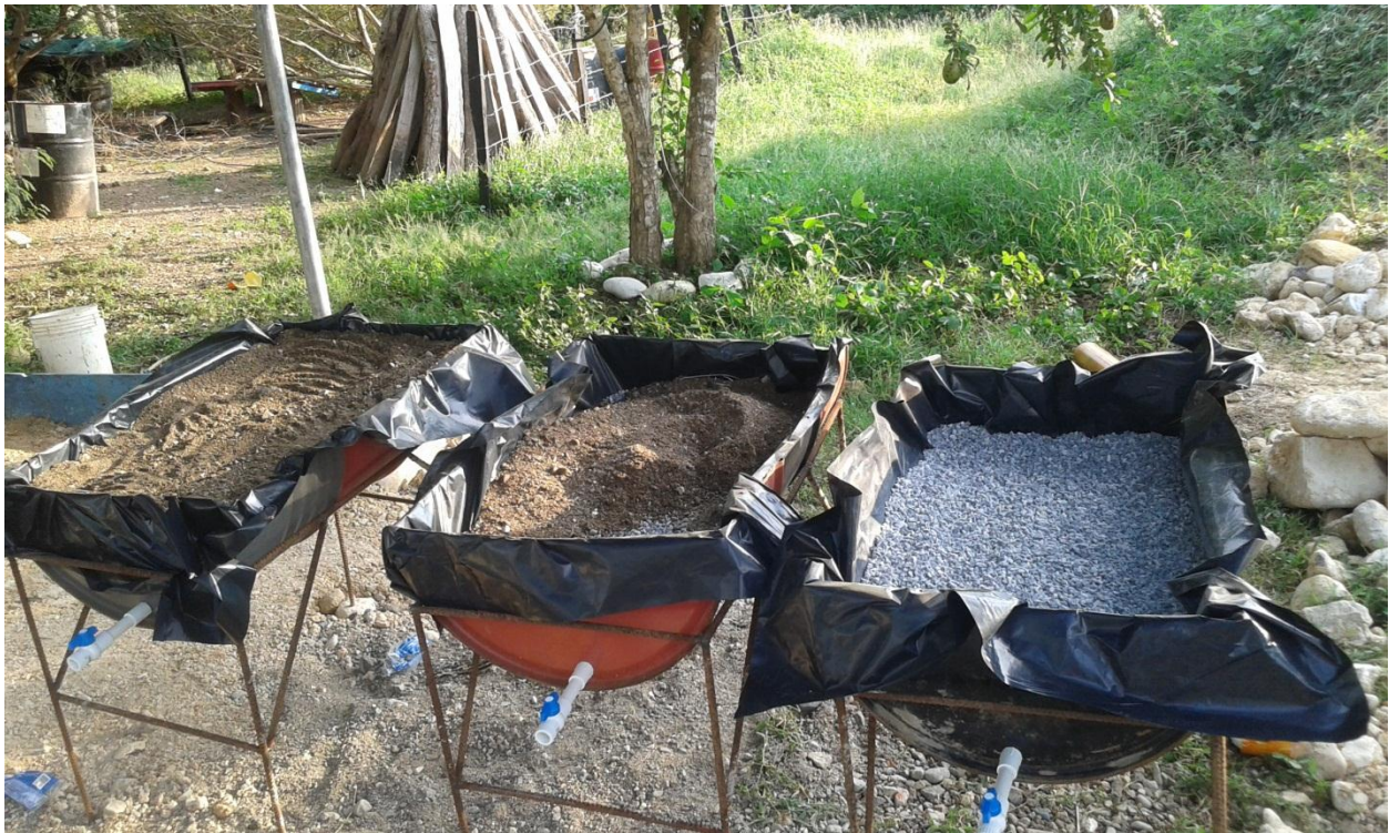
Sustrato utilizado en el sistema piloto (Grava, granito y Arena gruesa).
