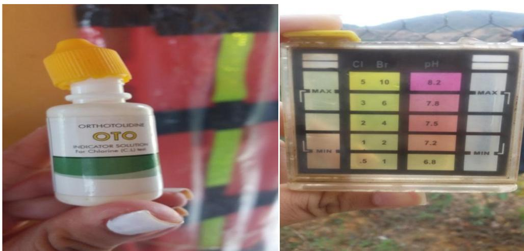
Figura 21. Kit medidor de Cloro y pH para piscinas
