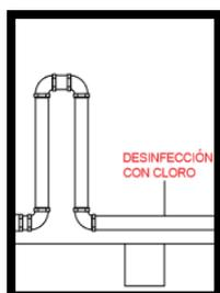
Para el caso de ACOSMI se emplea hipoclorito de calcio, en estado sólido, luego este es diluido y es aplicado por medio de una bomba dosificadora a uno de los tubos que conectan al tanque de almacenamiento, donde se consume la mezcla del hipoclorito con el agua del tanque.
