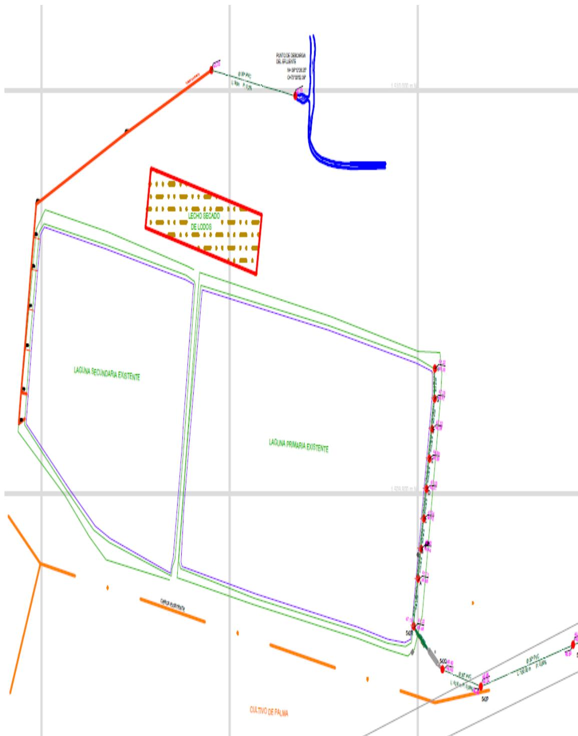
**Figura 15. Plano de las lagunas de estabilización del municipio de curumani.**
