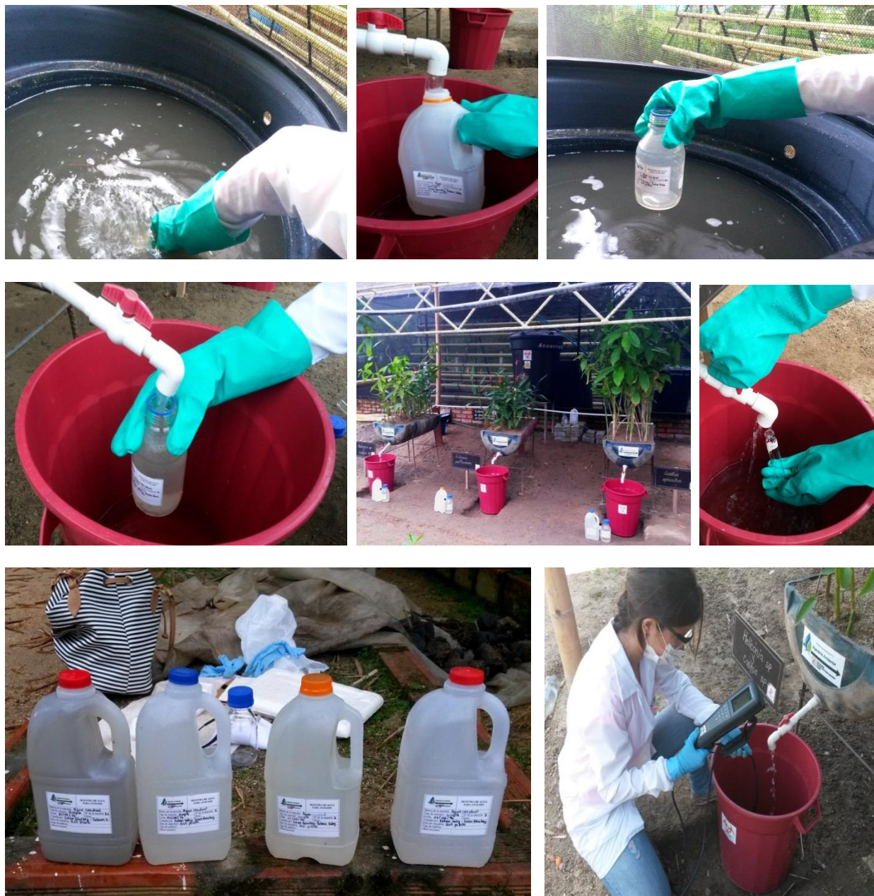
Recolección de las muestras y análisis in situ en el tanque aéreo y unidades experimentales.
