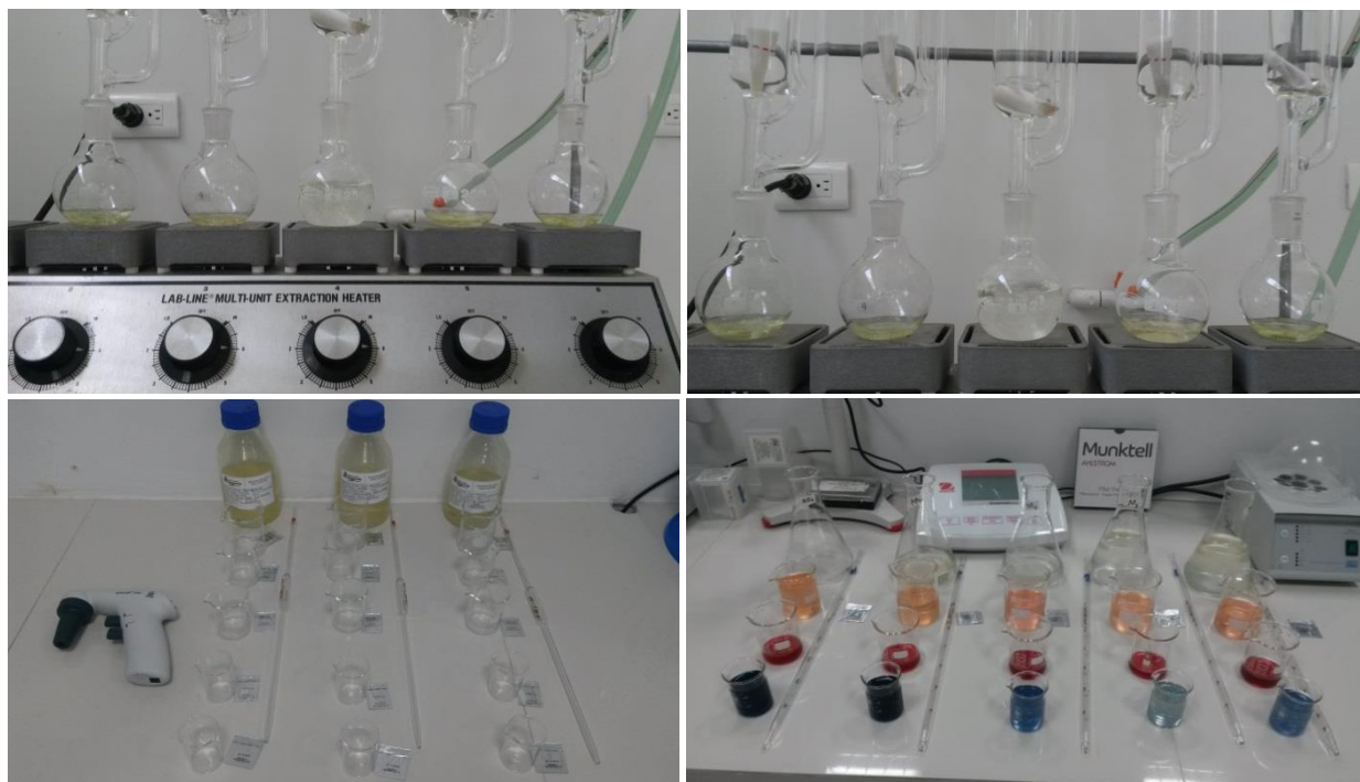
Procedimiento de extracción de grasas y aceites a través del método de soxhlet (arriba) y análisis de iones y metales pesados (abajo).
