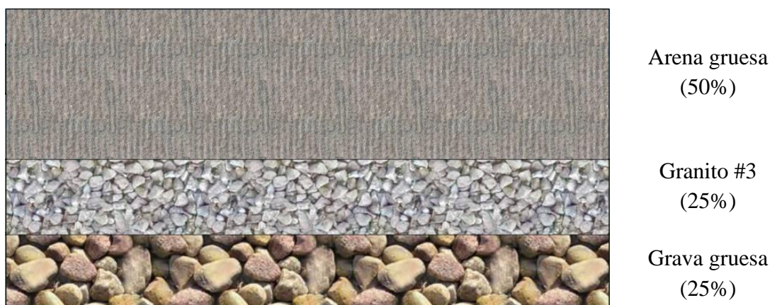
Figura 21. Sustratos seleccionados y su porcentaje en el medio filtrante. Fuente: Autores, 2016.
