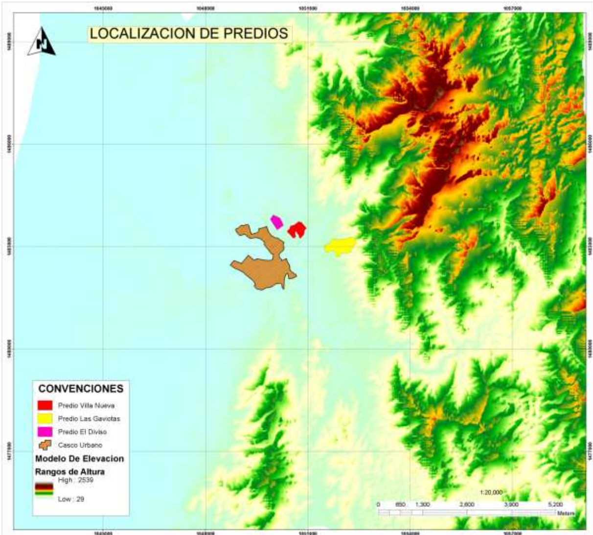
Figura N0 8, Modelo Digital De Elevación a 12mtrs en el tamaño de pixel, usado como insumo para el cálculo de la pendiente media de la zona de estudio en el proyecto, fuente. USSG.
