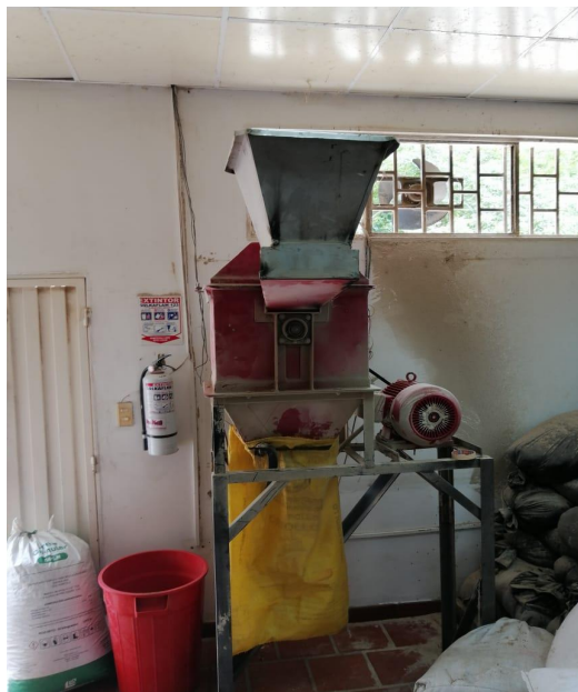
Figura 16. Foto del molino que será utilizado para el procesamiento de la hoja y ser convertida en harina.
