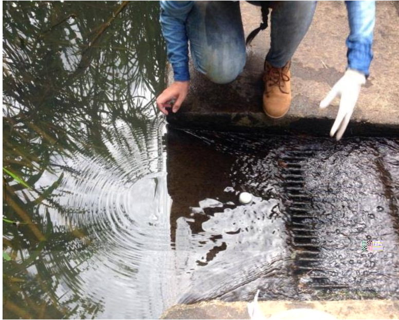
Figura 13. Aforo de caudal, método velocidad/Área. Fuente: Autores del proyecto
