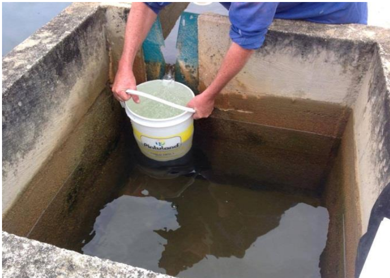
Figura 14. Aforo de caudal, método volumétrico. Fuente: Autores del proyecto
