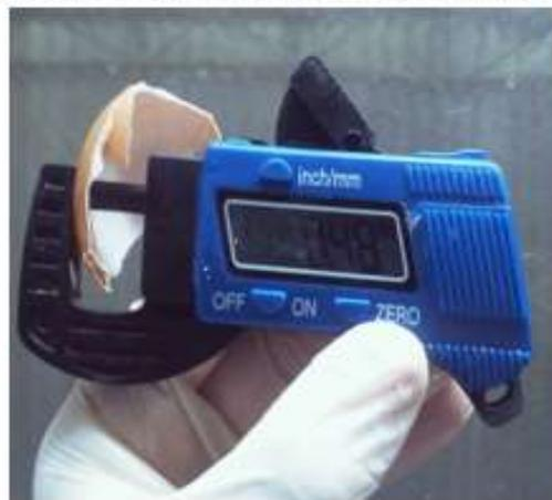
**Anexo 5. Grosor de la cascara (Micrómetro pie de rey)**
