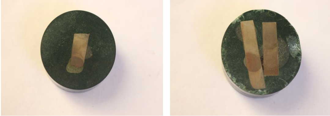
Figura 30. Montaje de las muestras en resina y ataque químico. a) Dado; b) Lateral
