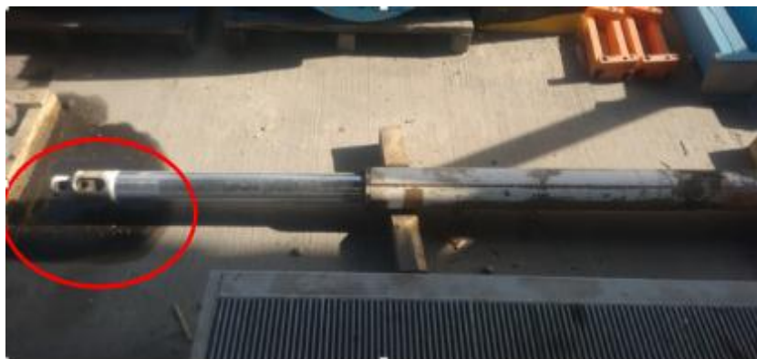
Imagen 20. Fuga de aceite por los empaques de un cilindro de nivelación del perforador UP108
