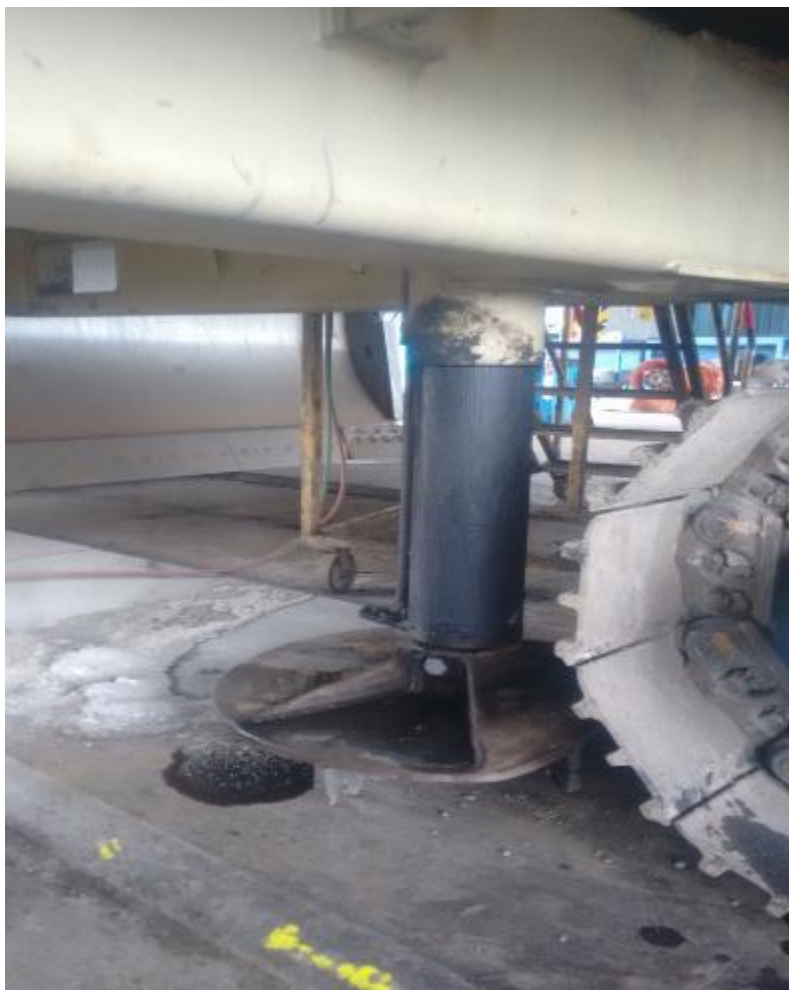
Imagen 14. Zapata y camisa del cilindro de nivelación
