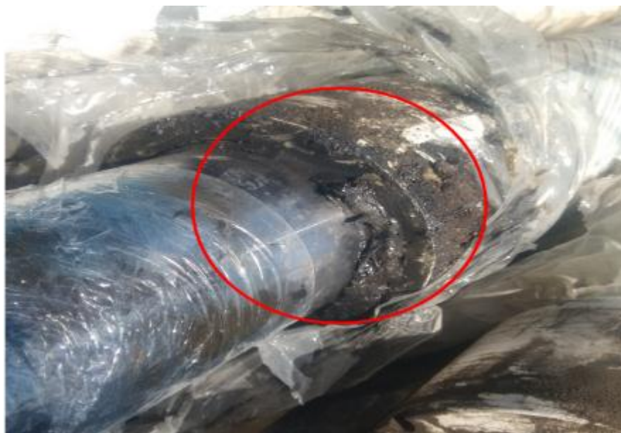
Imagen 21. Cilindro de nivelación con los sellos dañados fuga externa de aceite hidráulico
