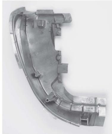
**Figura 30.** Panel de la puerta lateral de un BMW Z8.
