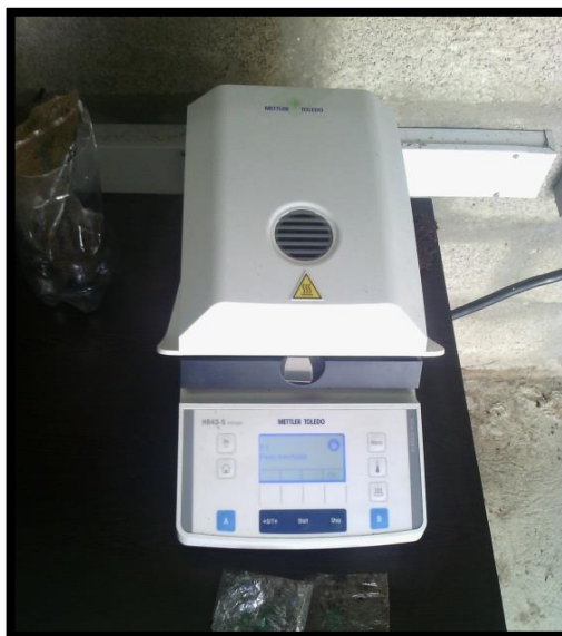
Foto 8. Medición de humedad de los subproductos (secador halógeno)
