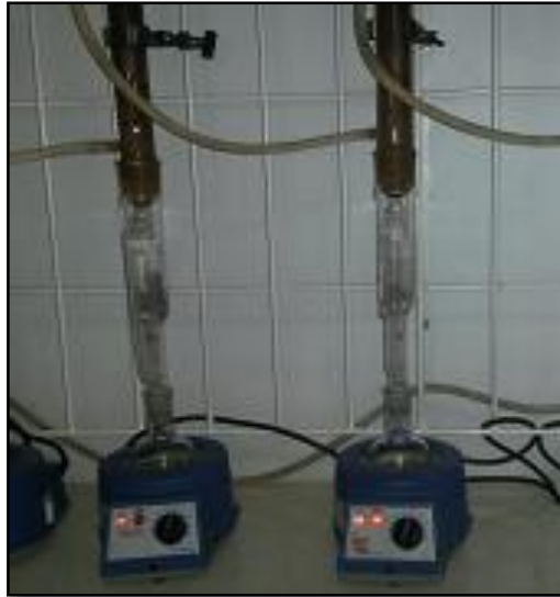
Fotografía 8. Montaje por método de Soxhlet
