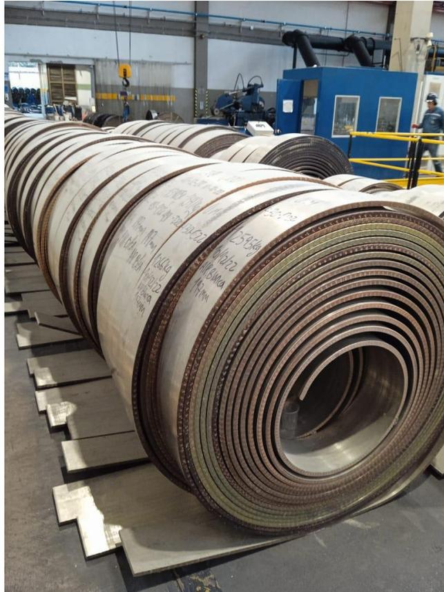
*Nota.* Flejes previamente fresados, enrollados y cortados con un peso aproximado de una tonelada.
