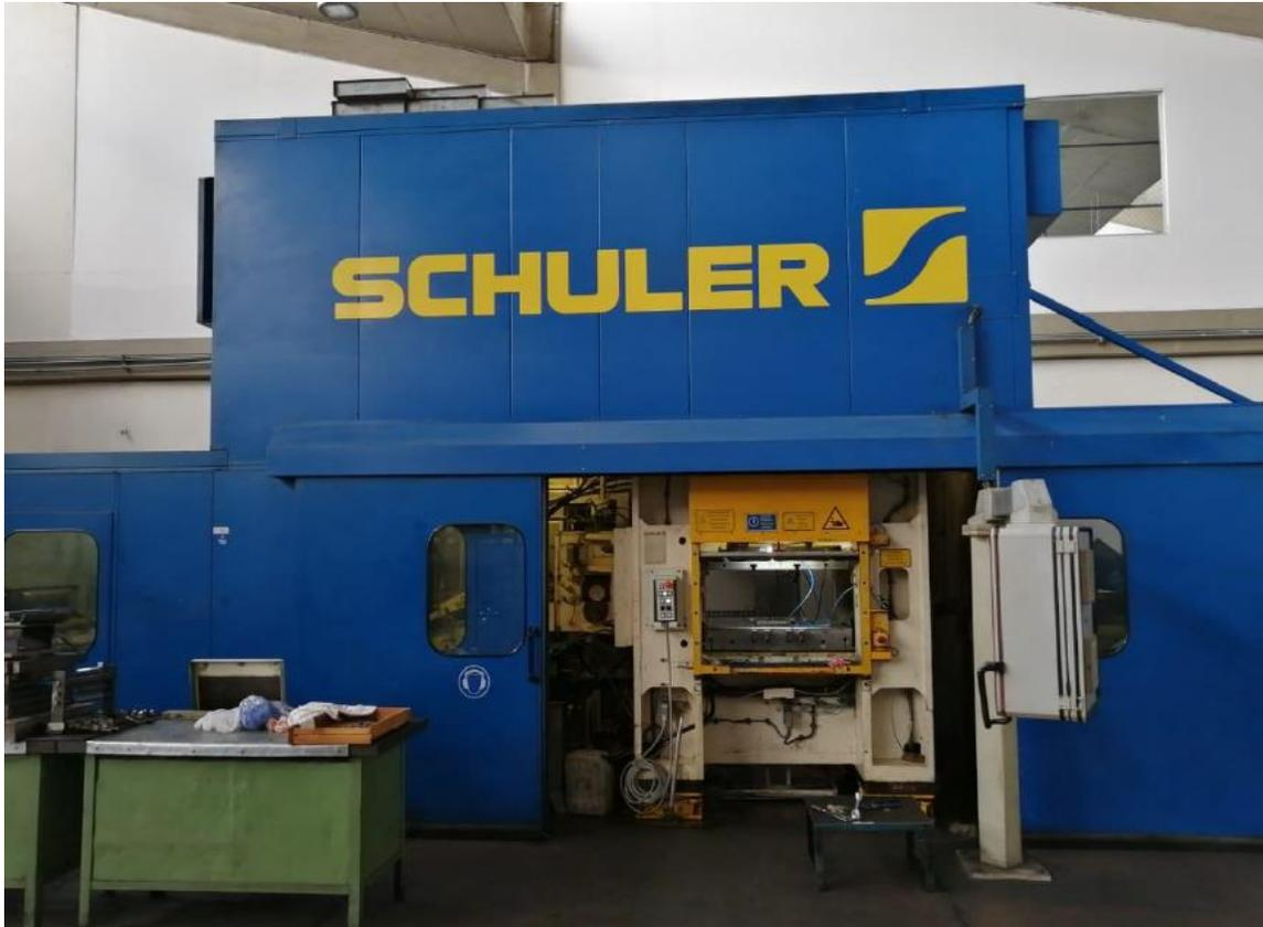
Nota. Máquina utilizada para el proceso de troquelado del fleje.
