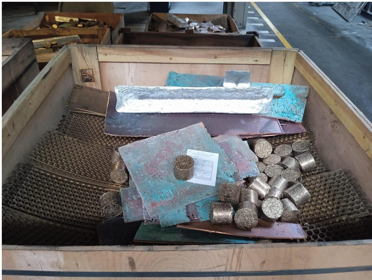
*Nota.* Carga traída del almacén y reciclada de los diferentes procesos de producción que serán utilizadas para fundirlas.
