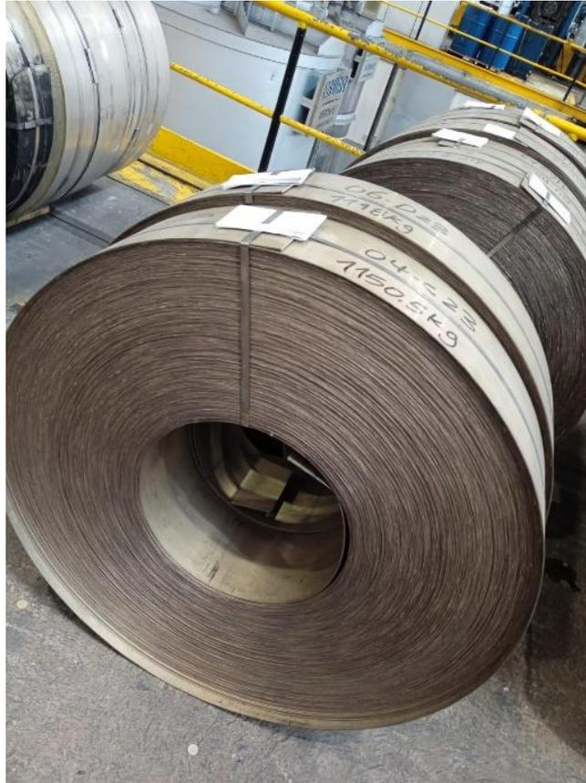
*Nota.* Fleje post Laminación 1, con un espesor aproximado de 3.9 mm.
