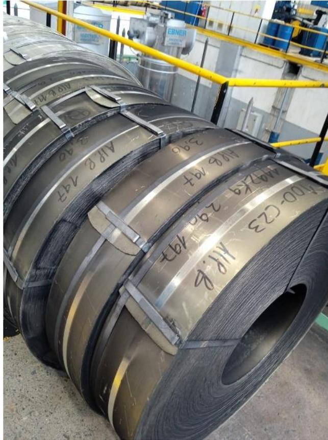
*Nota.* Fleje recocido, preparado para someterse a Laminación 2 y obtener su espesor final.
