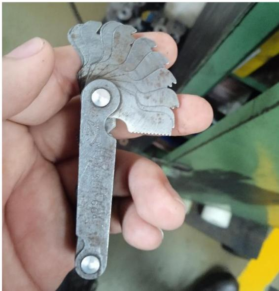
*Nota.* Galga de paso métrico utilizada para medir el paso de diferentes piezas roscadas.
