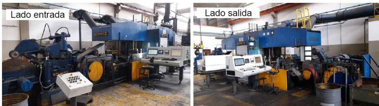
*Nota.* Lado entrada y lado salida por donde se transporta el fleje para el proceso de laminación (Fábrica de Moneda, 2022).
