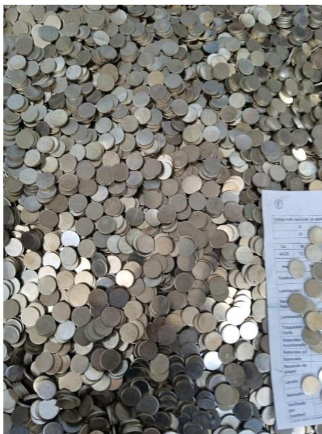
*Nota.* Discos separados del fleje en el proceso de troquelado.
