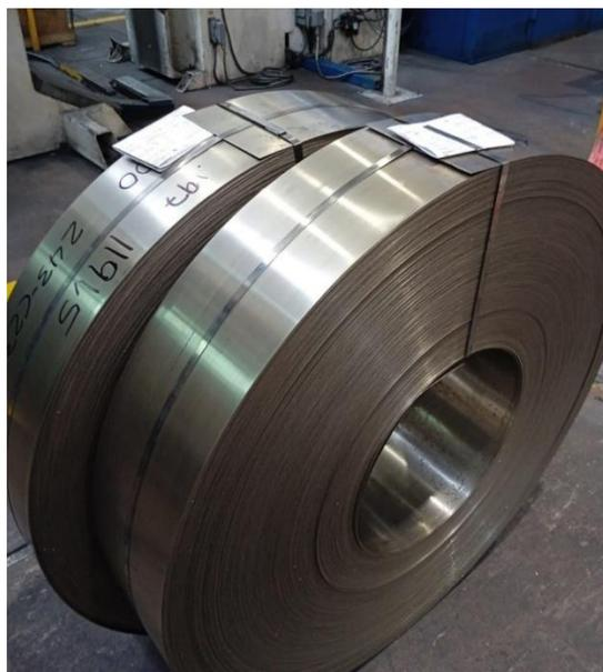
*Nota.* Fleje post Laminación 2, con un espesor que varía entre 1.30 mm y 2.70 mm, dependiendo del espesor necesario.
