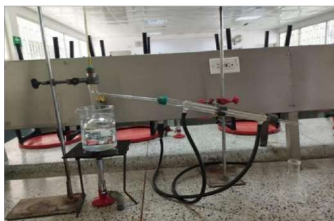
Figura 29. Montaje experimental para la destilación
