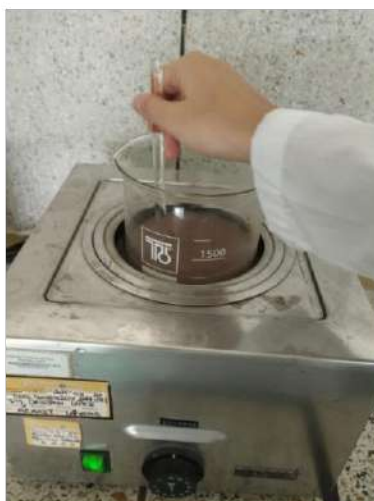
Figura 25 Montaje experimental de la pasteurización.
