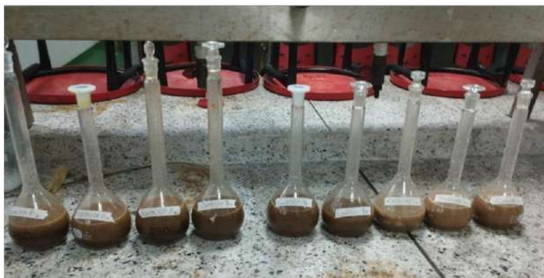
Figura 28. Montaje de fermentación, balones aforados.
