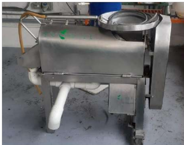
Figura 14. Lavador mecánico del Ecomill
