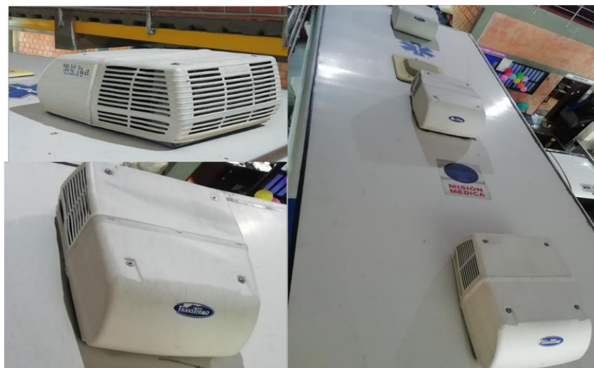
Figura 8. Aires acondicionados (parte externa).
