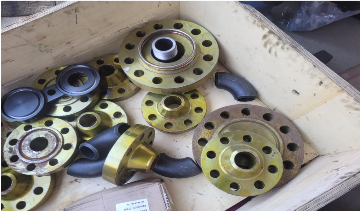
Figura 11 Recepción de materiales
