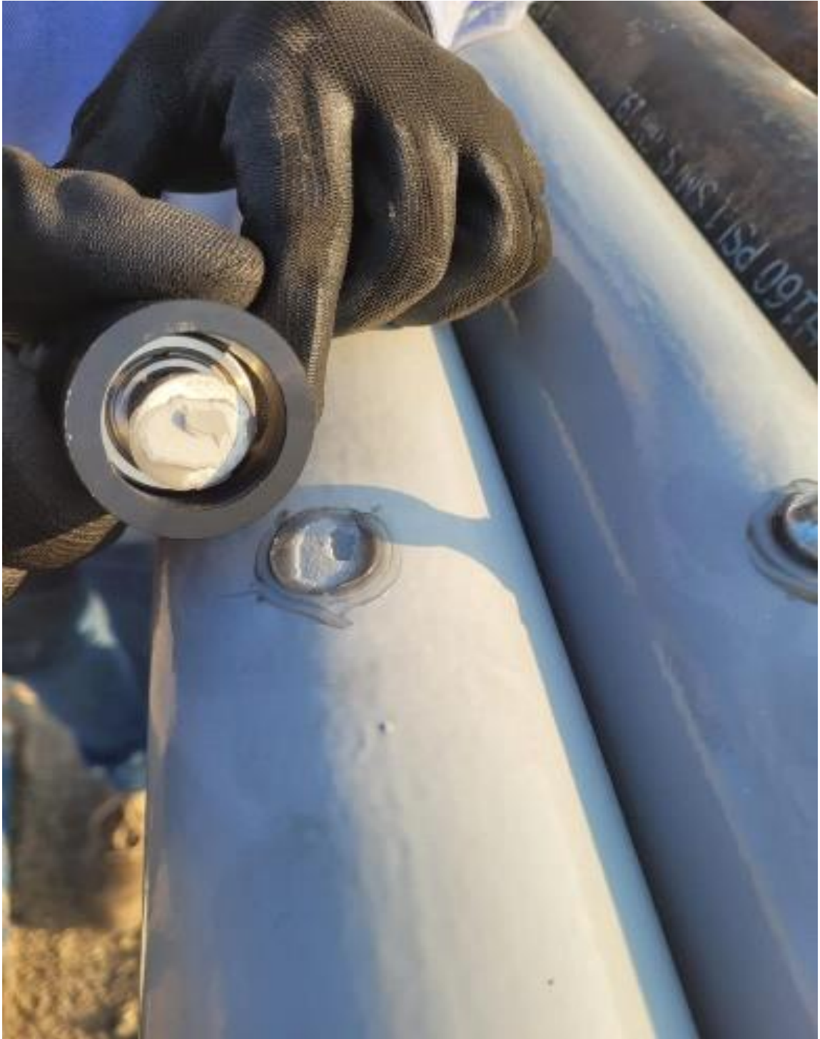
Figura 21 Dado despegado en prueba de adherencia
