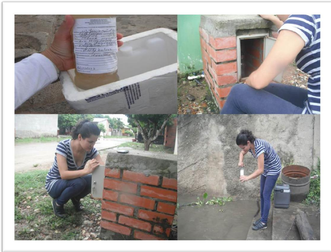
Imagen 16 toma de muestras de agua, desde grifos y en la fuente de captación de agua para potabilización.
