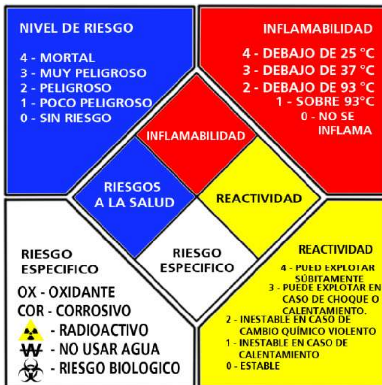
Figura 4. Rombo NFPA Identificación de Riesgos y peligros sustancias peligrosas.
