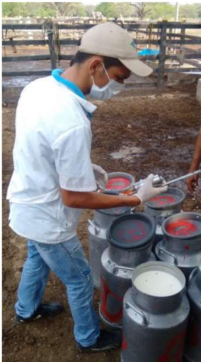
**Fotografía 5.** Prueba refractómetro
