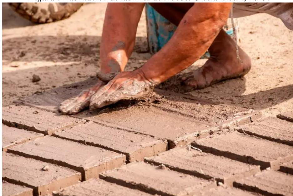
Figura 3 Fabricación de ladrillos de Adobe. Greelane.com, 2019.
