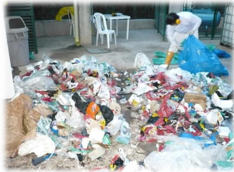
Fotografía 3: Separación de los residuos sólidos del cuadrante D por Método del Cuarteo
