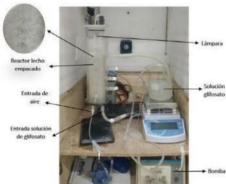
*Nota.* La imagen muestra el montaje del reactor para ensayos de fotodegradación. (Suarez, Guevara, 2019)
