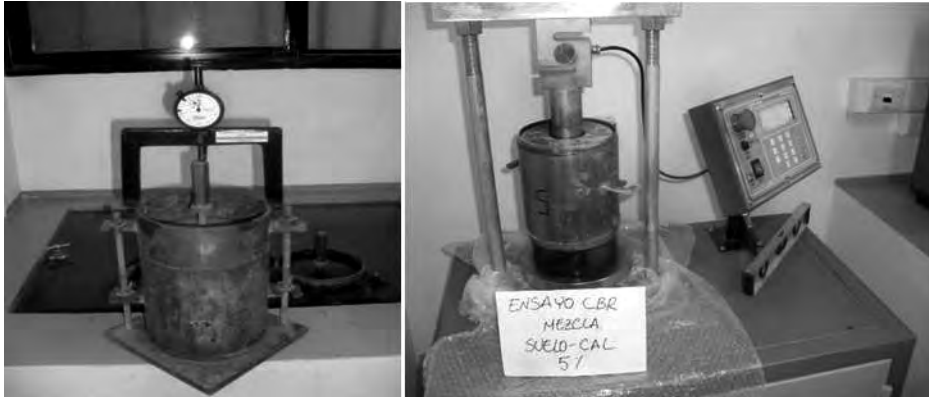
Figura 21. Muestras sumergidas para lectura de expansión y muestra lista para ensayo
