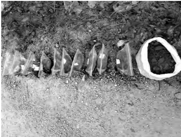
Figura 4. Muestras para ensayo de capacidad de intercambio catiónico, obtenidas a lo largo del sector para muestreo
