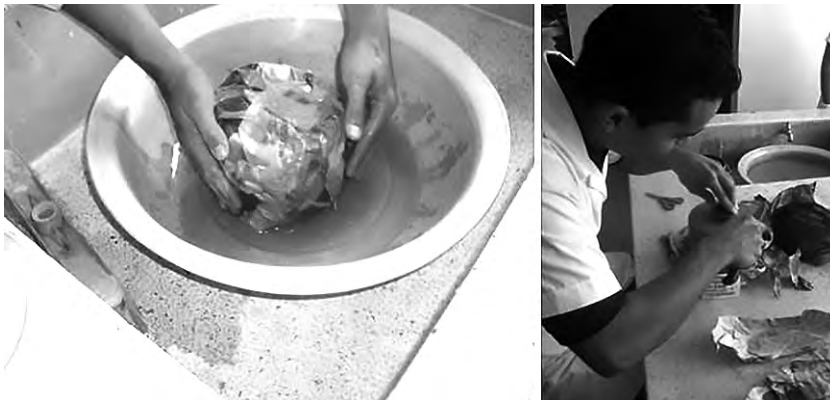
Figura 25. Protección de espécimen para proceso de curado y posterior tallado de muestra para ensayo
