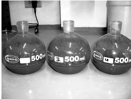
Figura 8. Picnómetros con muestras para ensayo de gravedad específica
