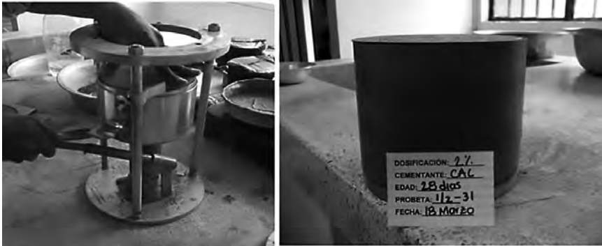
Figura 17. Extracción de espécimen compactado y listo para iniciar proceso de curado
