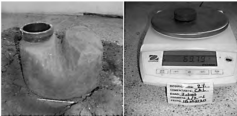
Figura 18. Tallado de Muestra a partir de espécimen compactado y muestra lista para ensayo
