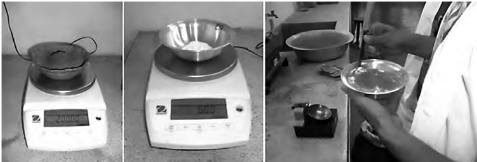
Figura 15. Proceso de mezclado suelo y el material cementante: cal
