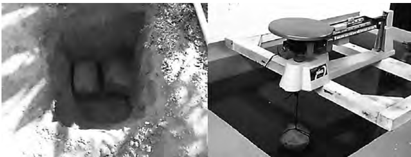
Figura 9. Toma de muestras inalteradas y determinación del volumen de la muestra en ensayo de peso unitario
