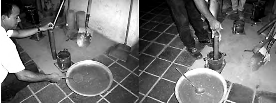
Figura 10. Realización del ensayo normal de compactación
