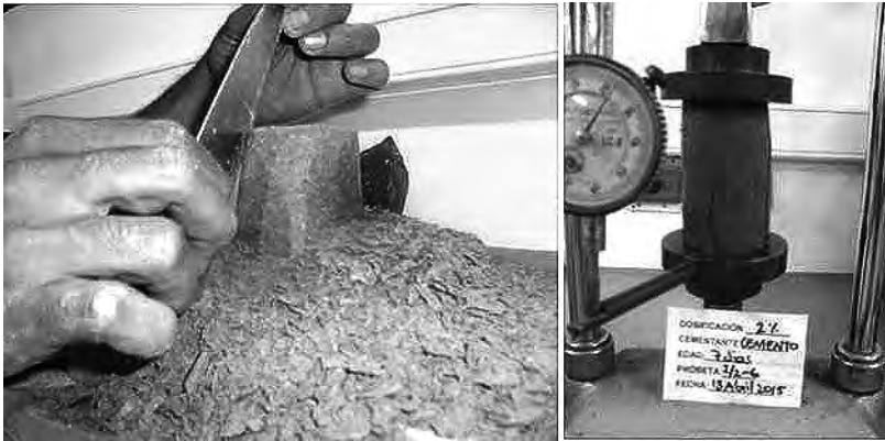
Figura 26. Tallado de muestra a partir del espécimen y posterior ensayo de esta
