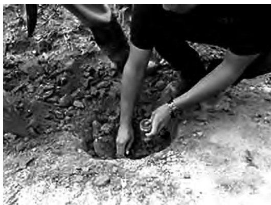
Figura 5. Toma de muestras para contenido de agua (humedad)
