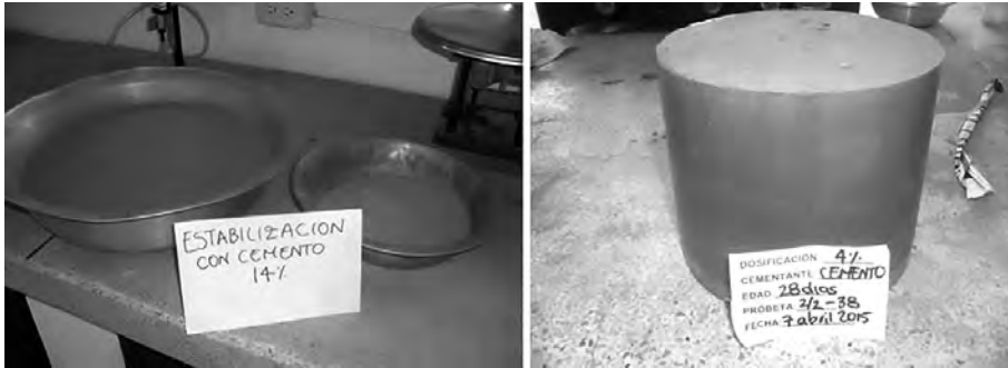
Figura 24. Preparación de mezcla y espécimen listo para proceso de curado
