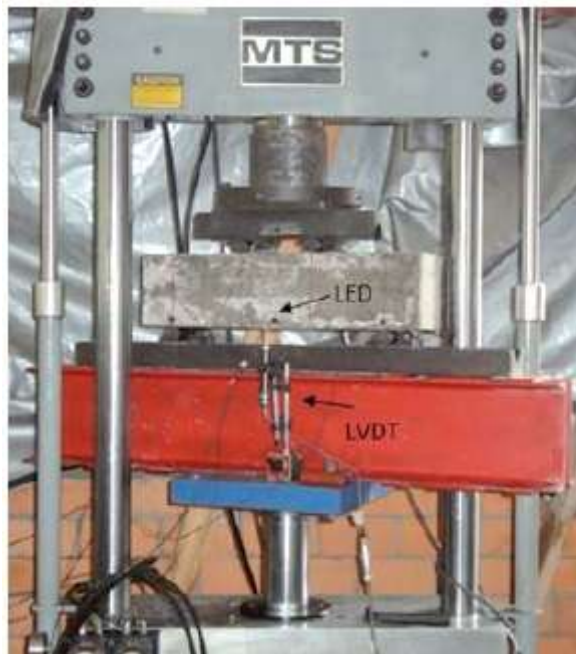
Figura 6. Dispositivo para la prueba de flexión y tenacidad. Fuente. Fibras sintéticas, Cemex, Colombia
