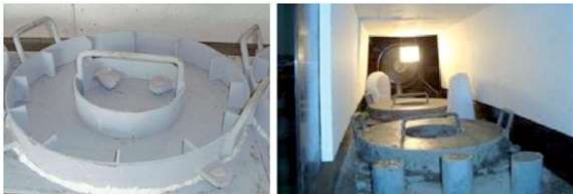
Figura 4. Anillo y equipo de la prueba de contracción plástica. Fuente. Fibras sintéticas, Cemex, Colombia
