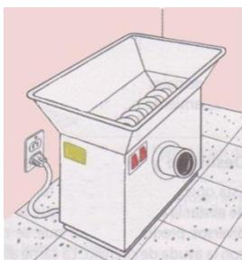
**Figura 10.** Molino industrial. Fuente: ITACAB. (s.f)c. Centro de Recursos para la Transferencia tecnológica. Recuperado el 24 de agosto de 2017, de Ficha Tecnológica. Gráficos: [http://www.itacab.org/adminpub/web/indexc8f2.html?mod=ficha&ficha\\_id=397](http://www.itacab.org/adminpub/web/indexc8f2.html?mod=ficha&ficha_id=397)
