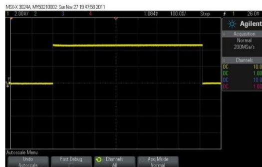
Figura 5. Simulación del pulso generado por el ultrasónico
