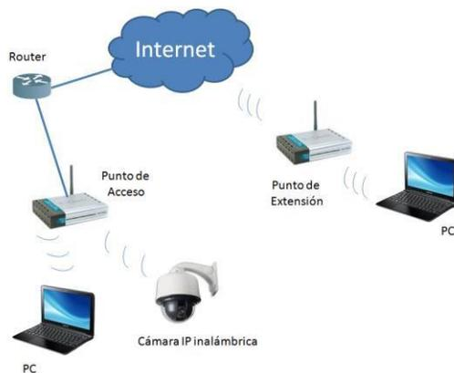
**Figura 4.** Ejemplo de conexionado de los puntos WIFI.
