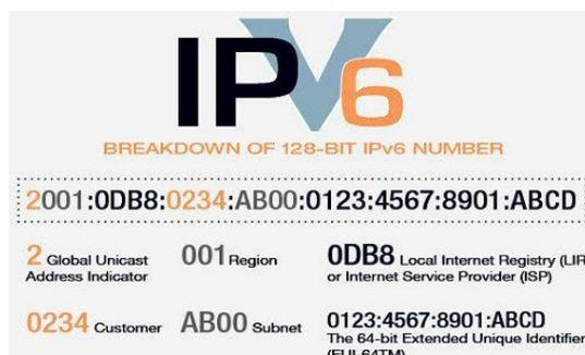
Figura 3 : Estructurada de una dirección IPv6
