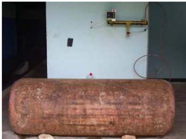
Foto 11. Bala de cloro gaseoso.
