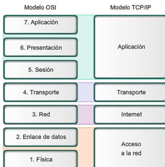
Figura 1. Modelo de referencia OSI y TCP/IP Fuente: http://angelitocesar.blogspot.com/2012/10/28-comparacion-del-modelo-osi-y-tcpip.html
