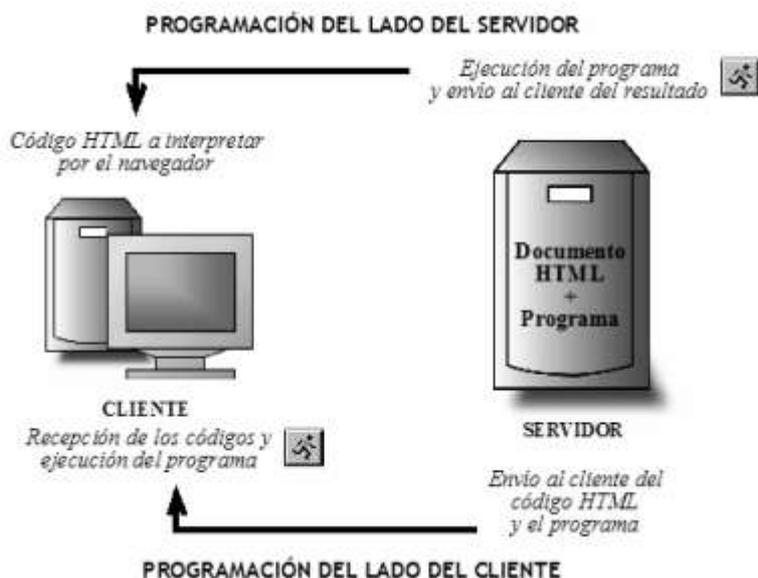
**Figura 6.** Diferencia programación del lado del servidor y del lado del cliente.
