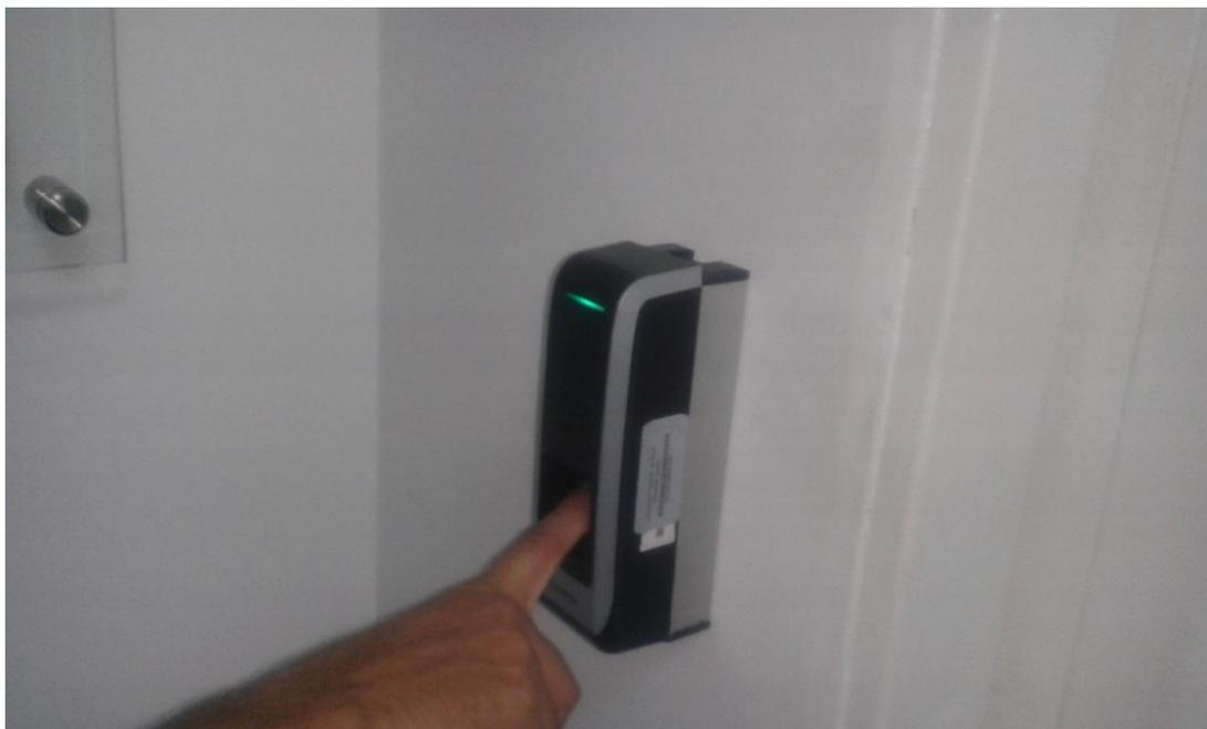
**Figura 57. Usuario autenticado o acceso permitido, sala de servidores. Fuente autor.**
