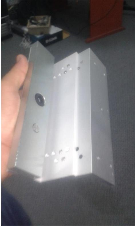
**Figura 24. Sujetadores de aluminio reforzados. Fuente autor.**
