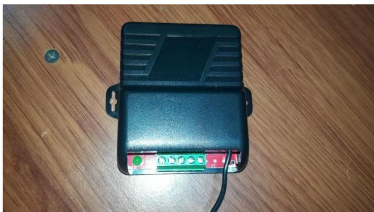
**Figura 33. SK-910RBQ canal de conexión. Fuente autor**
