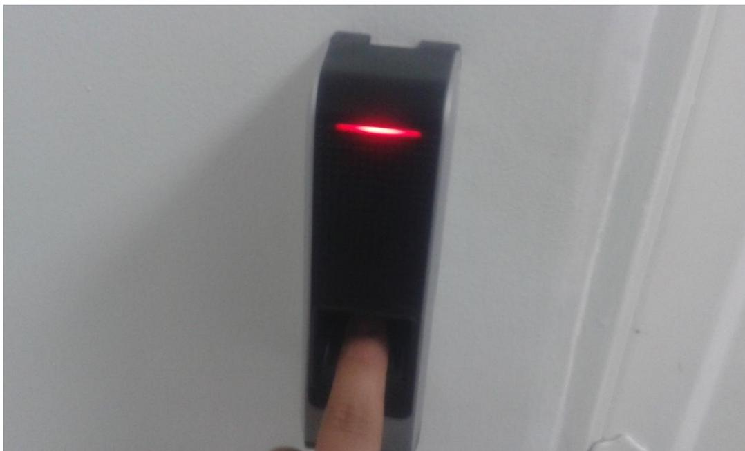
**Figura 55. Usuario no identificado o acceso no permitido, sala de servidores. Fuente autor.**
