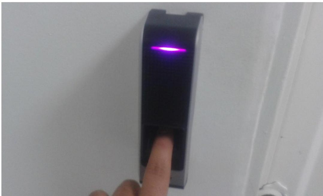
**Figura 56. Sensor escaneando huella, sala de servidores. Fuente autor.**
