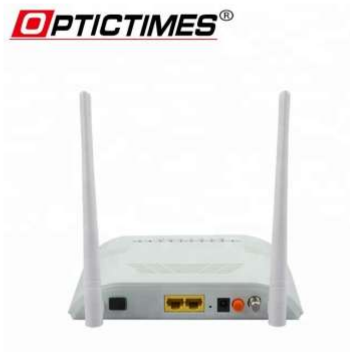
Figura 8 ONU (Optical Network Unit)
