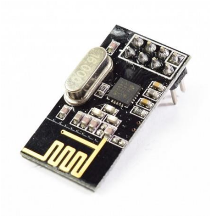
Figura 3. Módulo de radiofrecuencia NFRL2401
