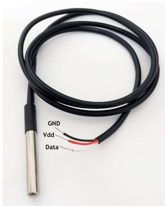
Figura 1. Sonda de temperatura DSB18b20
