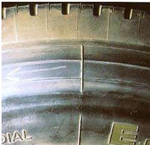
Figura 24. Desgaste circular por contacto entre neumáticos gemelos.
