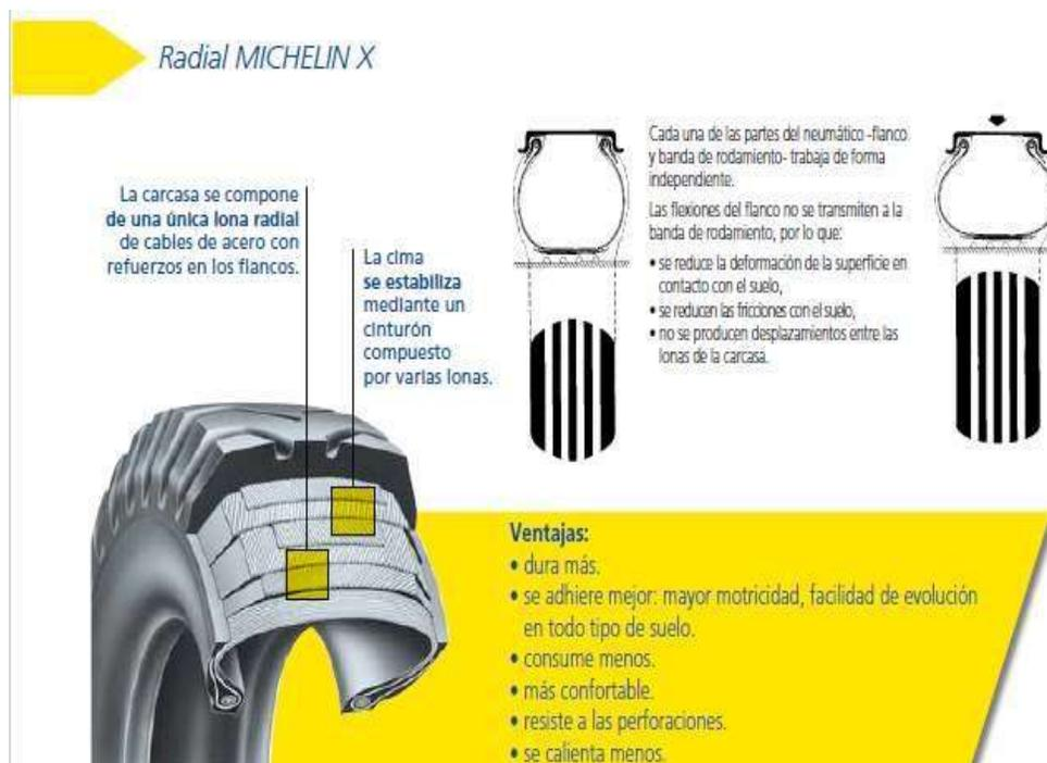
Figura 5. Neumático Radial
