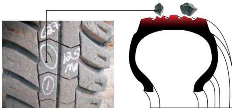
Figura 15. Corte en banda no pasante.
