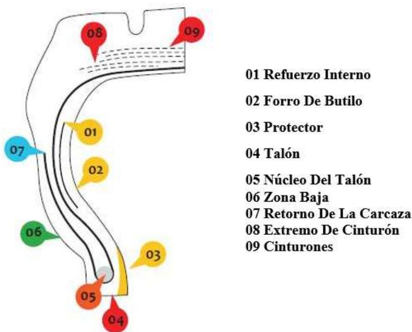
Figura 12. Estructura de la llanta
