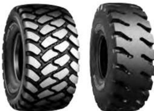
Figura 56. Patrón de huella para tracción y para roca.
