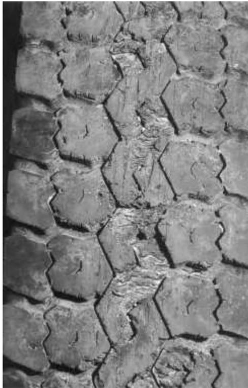
Figura 13. Desgarramiento de la banda de rodamiento
