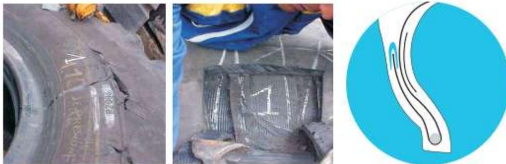
Figura 28. Separación mecánica en el costado.
