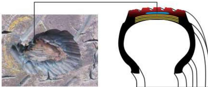
Figura 18. Separación por corte.
