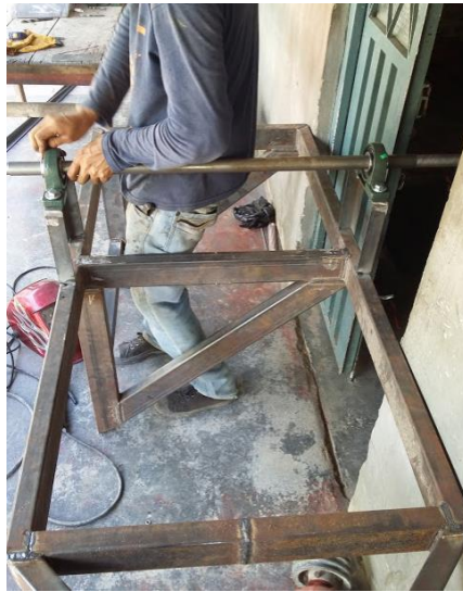
Ilustración 49. Alineación de rodamientos de llantas
