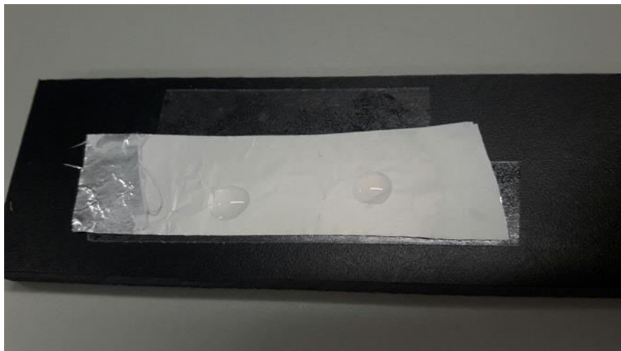
Figura 27 Probeta para realizar ángulo de contacto
