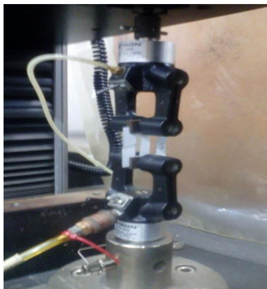
Figura 20 Probeta colocada en la máquina.
