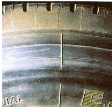
**Figura 26:** Desgaste circular por contacto entre neumáticos gemelos.
