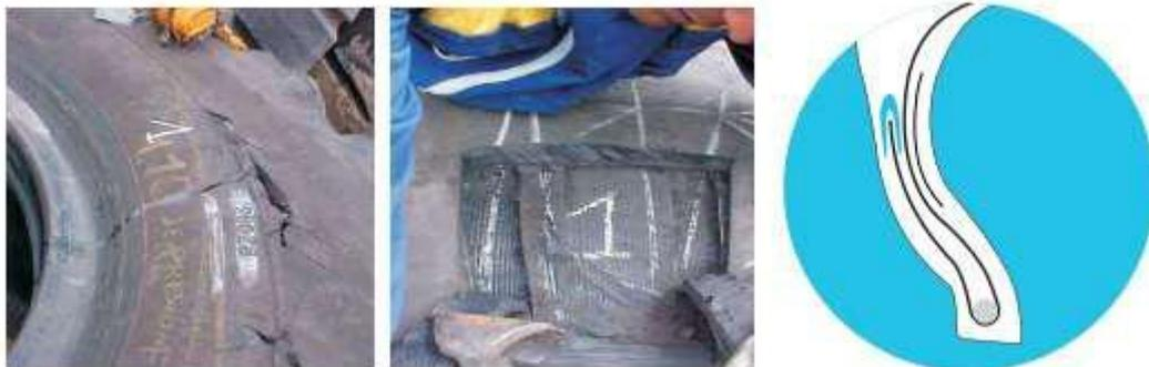
**Figura 30:** Separación mecánica en el costado.
