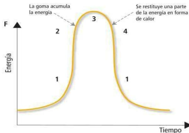
**Figura 10:** Energía y tiempo en el funcionamiento de la llanta.
