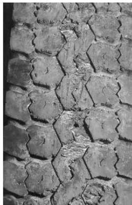
**Figura 16:** Desgarramiento de la banda de rodamiento Fuente: Guía de análisis de condiciones para la llanta radial.
