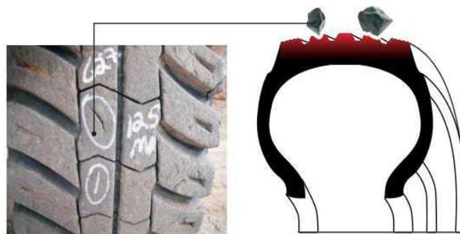
**Figura 18:** Corte en banda no pasante.
