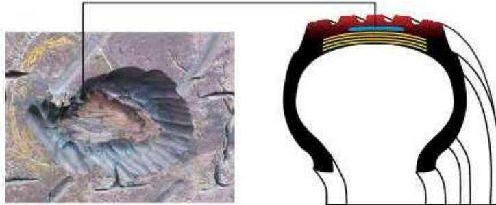
**Figura 21:** Separación por corte.
