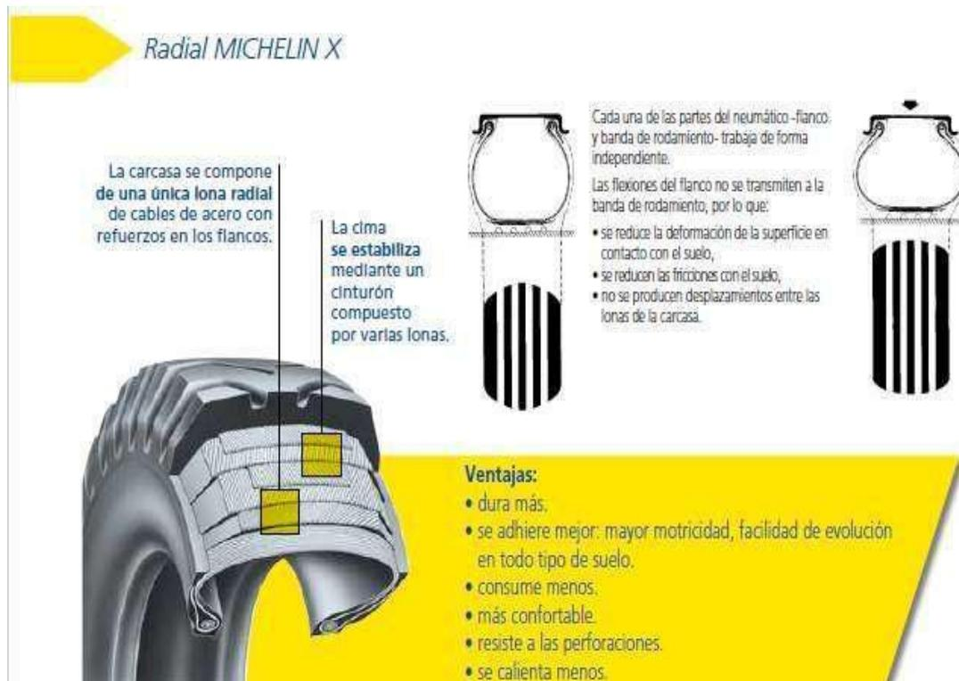
**Figura 5:** Neumático Radial
