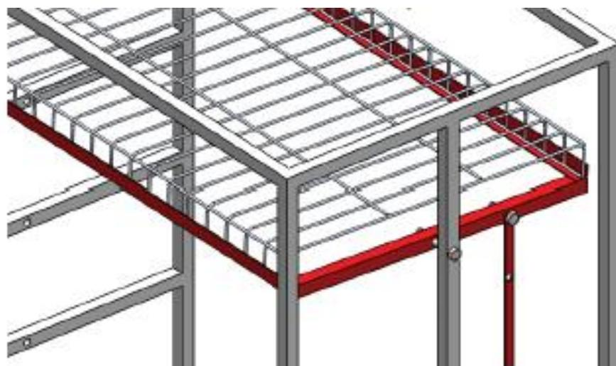
Figura 48. Fijación de las bandejas y su base.
