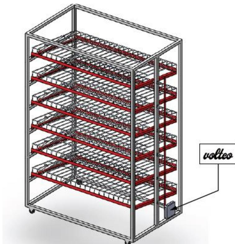
Figura 49. Ubicación del motor de volteo para las seis bandejas.
