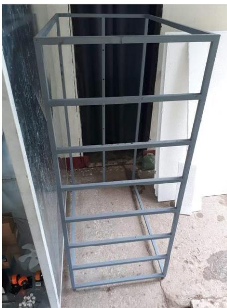
Figura 115. Construcción de la estructura interna.
