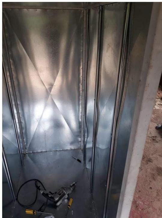
Figura 124. Adaptación de las guías para los portabandejas en la nacedera.
