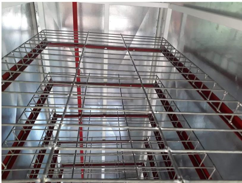
Figura 126. Instalación de las rejillas en la incubadora.
