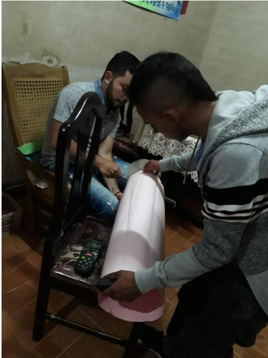
Figura 24. Calculo del flujo de aire con el anemómetro.
