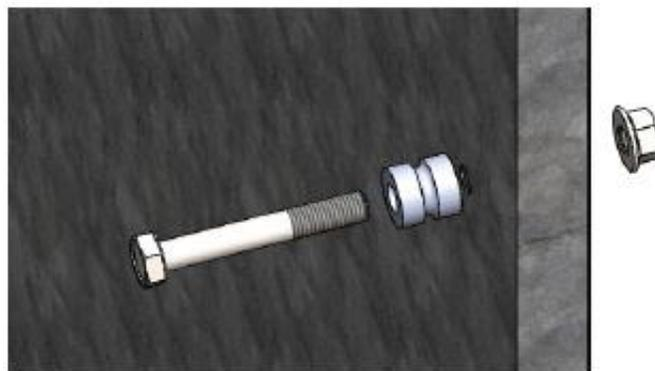
Figura 44. Postura del tornillo en la parte superior (Resistencia).
