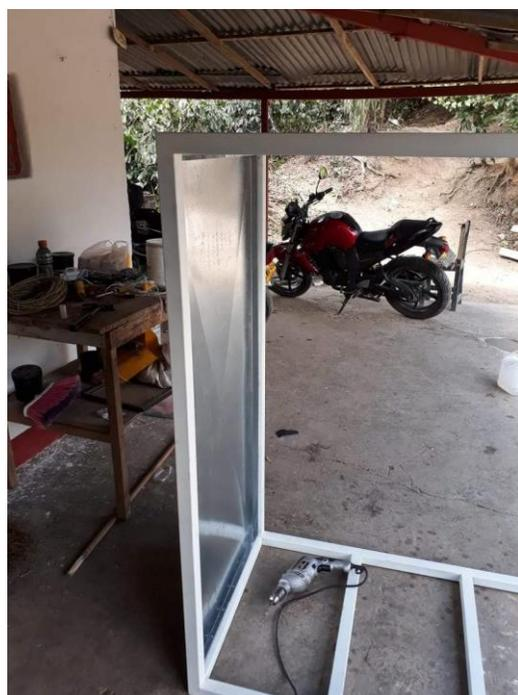
Figura 119. Instalación de las tapas laterales I.
