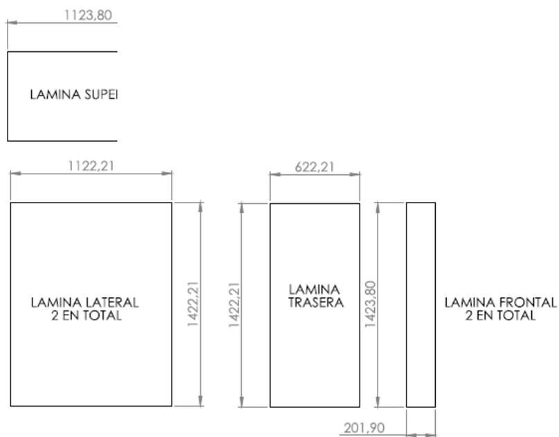
Figura 100. Vista general de las láminas de poliestireno expandido.
