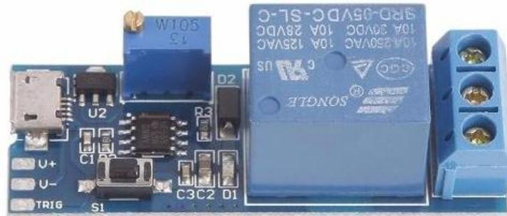
Figura 26. Temporizador con señal de entrada
