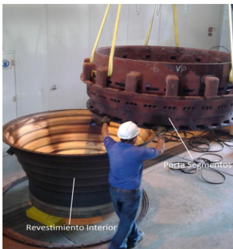
Figura 14. Revestimiento interior y porta segmentos de la cámara de combustión
