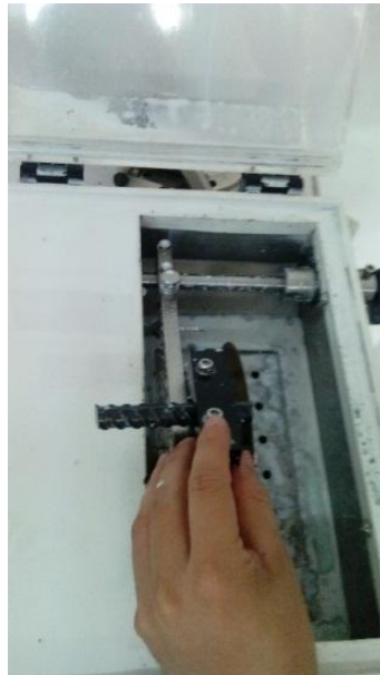
Figura 10. Extracción de la probeta para el análisis metalográfico.
