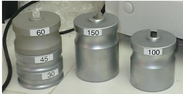
Figura 7. Cargas para los diferentes tipos de dureza Rockwell.
