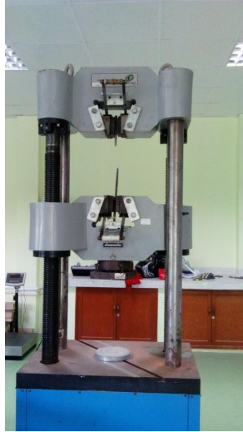
Figura 23. Instante de falla de la probeta
