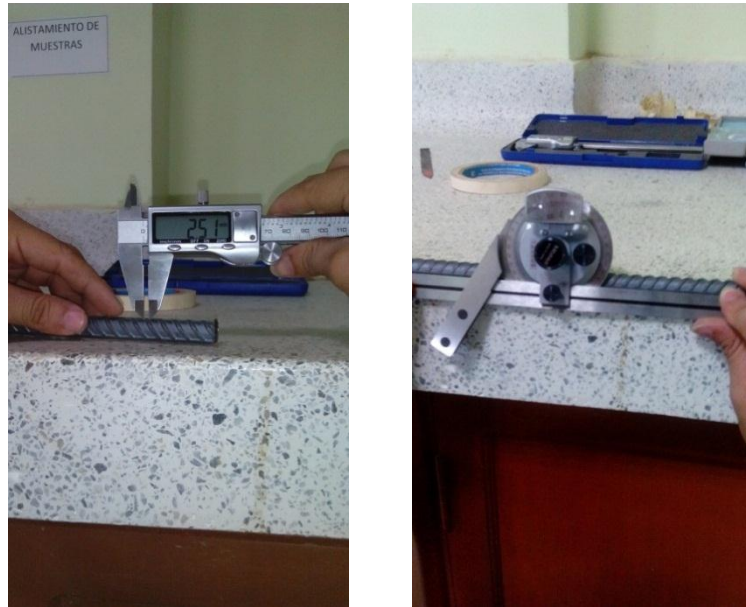
Figura 22. Medición del espesor y Angulo de la vena de las varillas
