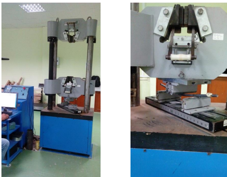
Figura 44. Ensayos de flexión en 4 apoyos.
