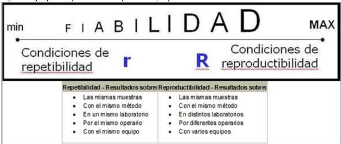
Figura 2. Ejemplo comparativo entre repetibilidad y reproducibilidad.
